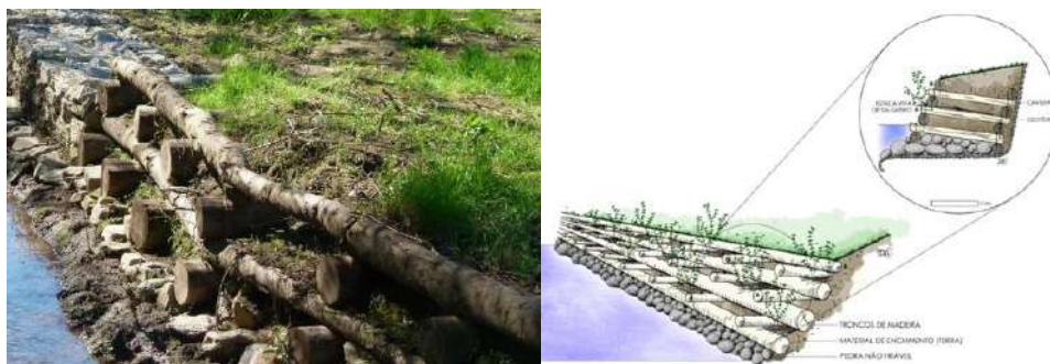
Figura 43 – Muro vivo (fotografia, secção transversal e alçado)
