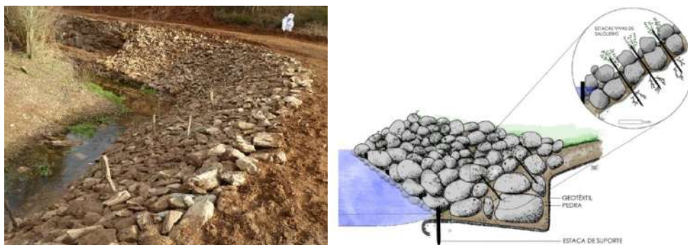
Figura 39 – Enrocamento vivo (fotografia, secção transversal e alçado)
