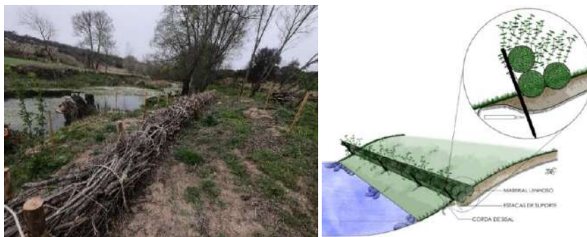
Figura 38 – Faxina viva (fotografia, secção transversal e alçado)
